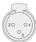
SALIDA DMX Conectores XLR (vista trasera)
